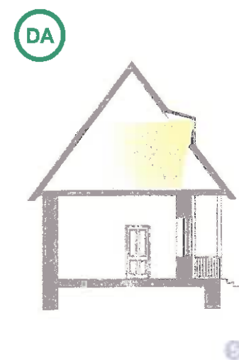
AȘA DA: Introducerea luminii printr-o lucrămă poate fi o soluție de iluminat eficientă pentru spațiile de la mansardă.
